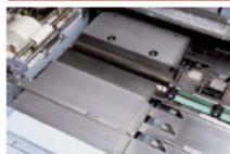
ニッキング機構が自動でセットされます。強力なニッキングで、表紙と本身を確実に吻合します。製本条件に合わせて、ニッキング時間、ニッキング待ち時間をタッチパネルから設定できます。
