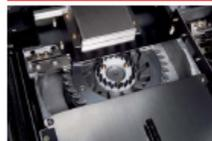
ミーリングガイド機構が自動でセットされます。ミーリングは強力モーターによる回転カッターとが入れ対で、所定の製本物でも確実に削加工します。また、切り込み量は0mm～4mmまでの調整が可能です。
