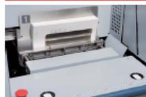
クランパー機構が自動でセットされます。本身を強力にクランプ、ミーリング部やニッキング部での本身のずれを防止します。安全ビームが標準装備されており、安全に作業ができます。
