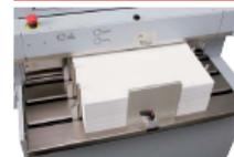
表紙給紙ガイドが自動でセットされます。一部に1.6mmまで確める大容量表紙給紙装置を標準装備し、選別して製本作業が行えます。上置紙70～260kg、コート紙90～300kg(両六両造書)の様々な種類の表紙を給紙できます。
