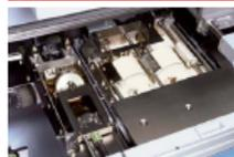
糊塗布量、糊切りタイミングなどが自動でセットされます。2つの大径正転ローフの組み合わせで、糊塗布を確実に塗布できます。また、糊槽ローフ径程とは別タンクを装備しているので、異なる糊塗布の塗布ができます。
