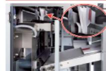
デリバリガイド機構が自動でセットされます。冊子受け取りフールが昇降し、冊子を正しい位置で受け取るため、厚い製本物でも確実に受け取ることができます。
