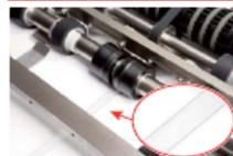
筋が幅、基準位置がタッチパネルから入力するだけで自動でセットされます。厚手の表紙にもシロカワリと筋入れを行い、角のゆるいシヤープな製本が可能です。オプションの筋入れローフで、角と肩開きに4本の筋入れが行えます。
