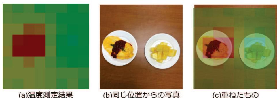
図6. サーモパイルアレイによる温度測定の結果
